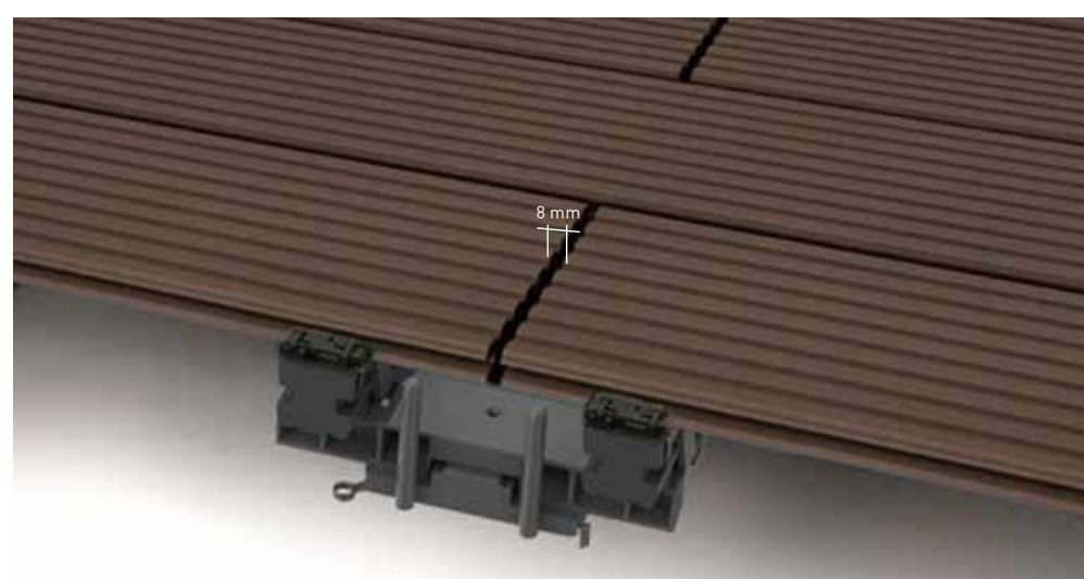
Čelni razmak dasaka min. 8 mm, kod podne ploče 5 mm. Za optimalnu sliku fuge koristite Distanz Fix.
